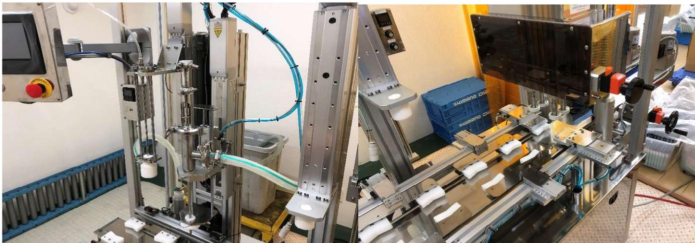
↑エア-洗瓶部・充填ノズル昇降部・中栓打栓部    ↑中栓打栓部・キャップ部
